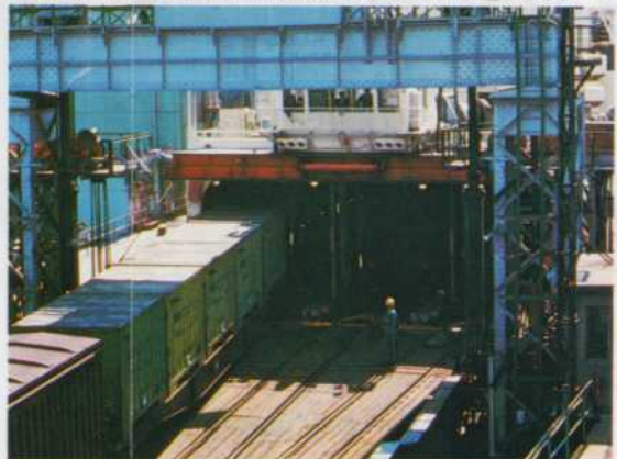
▼連絡船貨車航送 荷物を積んだ貨車をそのまま運びます。
