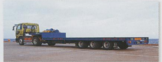
[荷台寸法]長さ:9.300m 幅:2.990m 地上高(床面):0.890m
