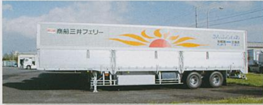
[内寸法]長さ:12.597m 幅:2.370m 高さ:2.325m
