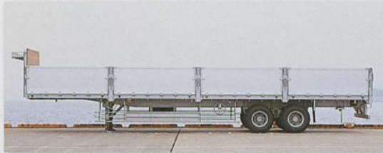
[内寸法]長さ:11.765m 幅:2.390m 地上高(床面):1.450m ※他に長さ13mタイプもあります。
