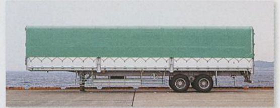
[内寸法]長さ:12.600m 幅:2.370m 高さ:2.200m
